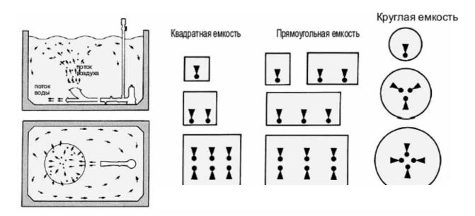
**Эжектор BER** может устанавливаться на твердое дно емкости, озера и т.п. или на изготовленную платформу с необходимыми коммуникациями с берега.
